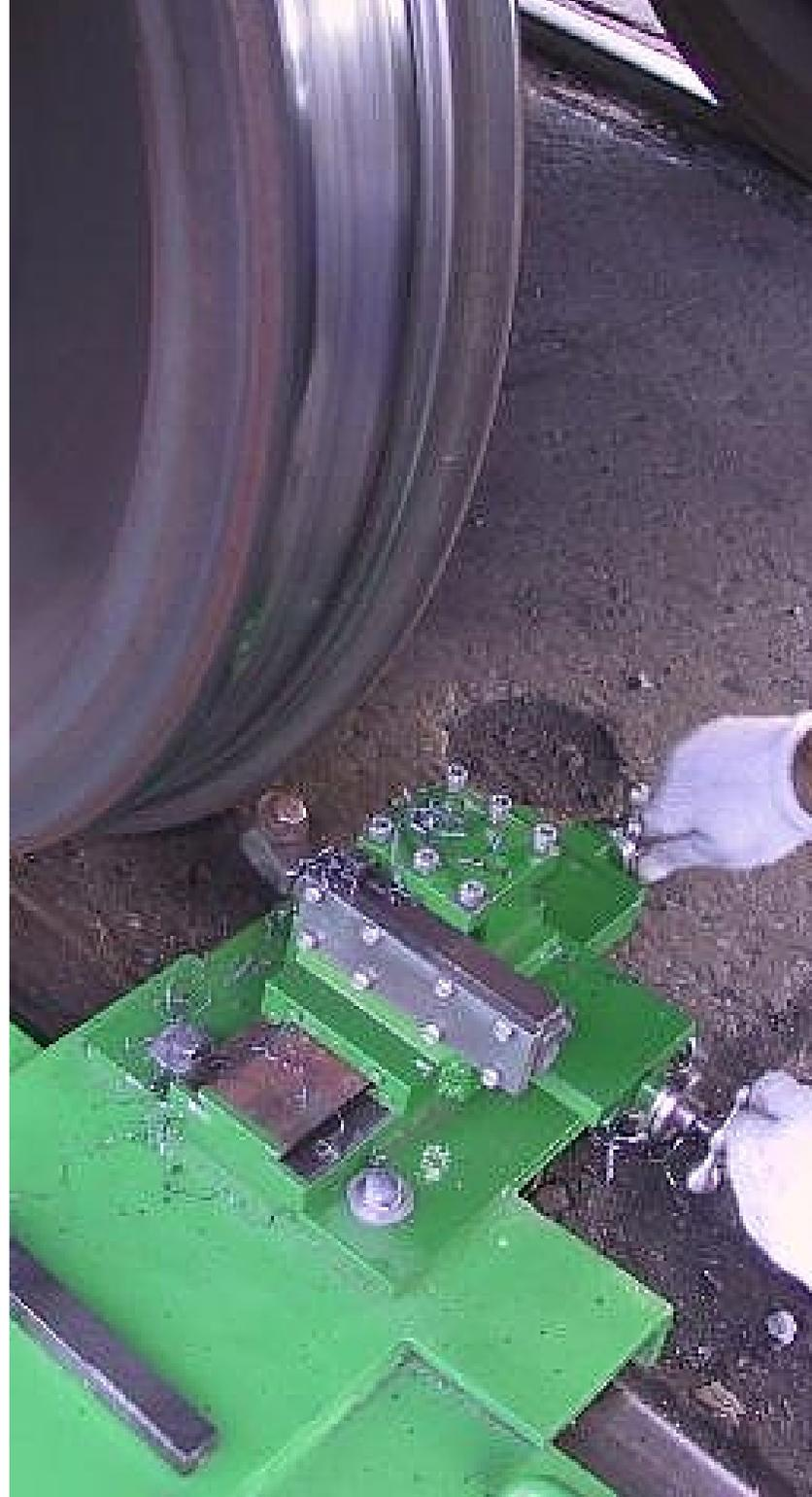
Фирма 1AK200 Ltd. г. Нарва, Эстония производит мобильное устройство 1AK200 предназначенное для обточки колес железнодорожного подвижного состава.
